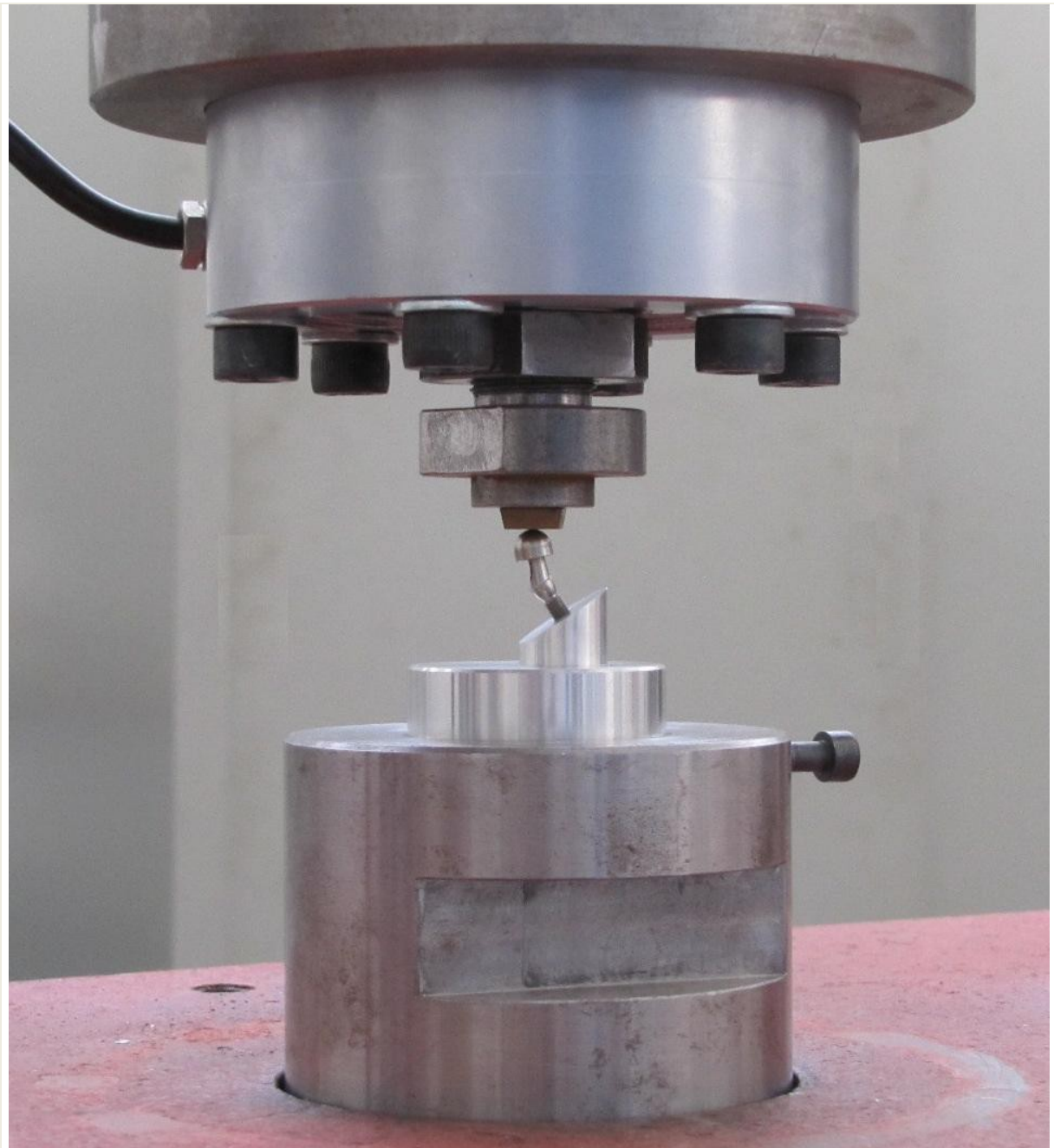
Figura 3 : Configurazione utilizzata per la verifica della prova verticale con carico dinamico
